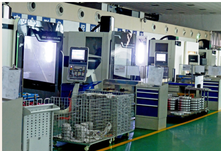
Bild 10: Mechanische Bearbeitung auf modernen Mehrachsenbearbeitungszentren (Quelle: Metreg Technologies GmbH)
